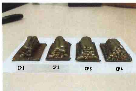
Figura 12 – Corpos de prova soldados seguindo os parâmetros de confecção descritos na Figura 11.
