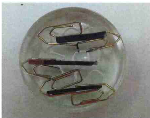
Figura 15 - Amostras de 253MA ensaiadas a 900, 1000 e 1100 °C embutidas em resina de cura frio.
